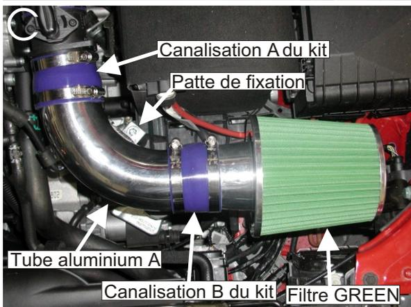
Fixer le tube aluminium A à l'aide de la vis fournie sur le support de la boîte à air.(schéma C)
