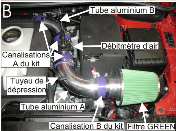
Positionner le tube aluminium B à l'aide de la canalisation du kit en lieu et place de la canalisation d'origine.(schéma B)
