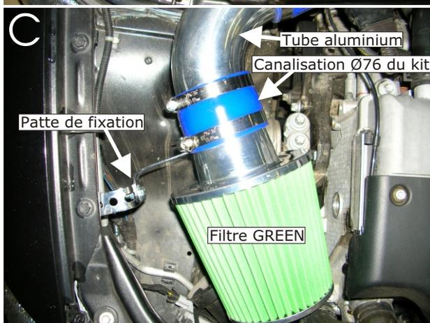
Fixer le filtre à air GREEN à l'aide du kit de fixation fourni.(schéma B et C)
