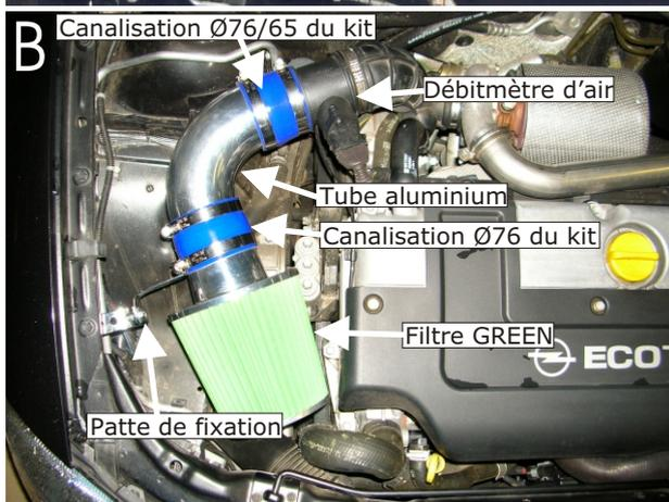
Emboîter la canalisation Ø76/65 du kit sur le débitmètre d'air(schéma B)
