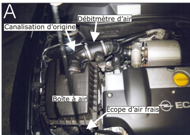
Déposer et supprimer la boîte à air d'origine ainsi que la canalisation d'origine.(schéma A)
