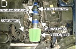
Positionner le filtre à air GREEN à l'aide de la patte de fixation et du silent bloc sur le support de la batterie.(schéma C et D)
