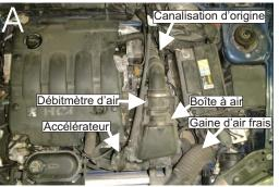
Déposer et supprimer la boîte à air complète .(schéma A)
