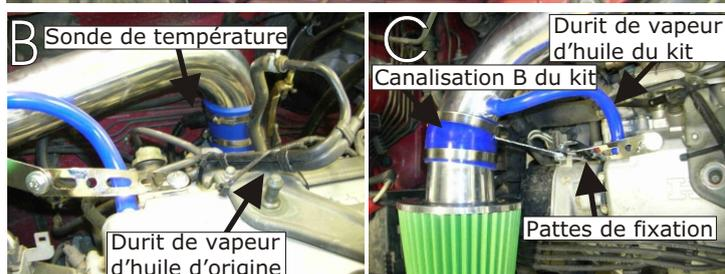
Emboîter le tube aluminium sur la canalisation A du kit.(schéma D)
