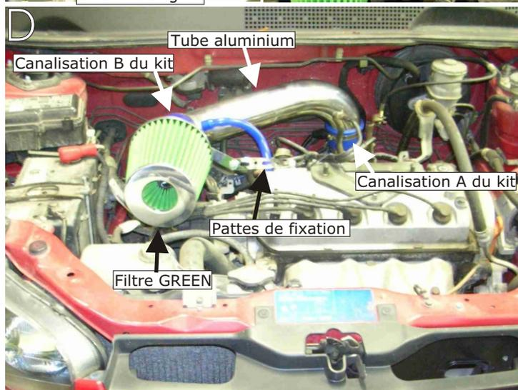
Emboîter le filtre à air GREEN sur le tube aluminium à l'aide de la canalisation B du kit.(Schéma C et D)
