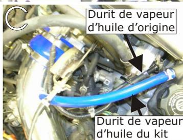
Emboîter la canalisation A du kit sur le boîtier papillon des gaz.(schéma D)
