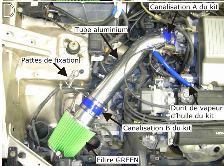
Emboîter le filtre à air GREEN sur le tube aluminium à l'aide de la canalisation B du kit.(schéma D)
