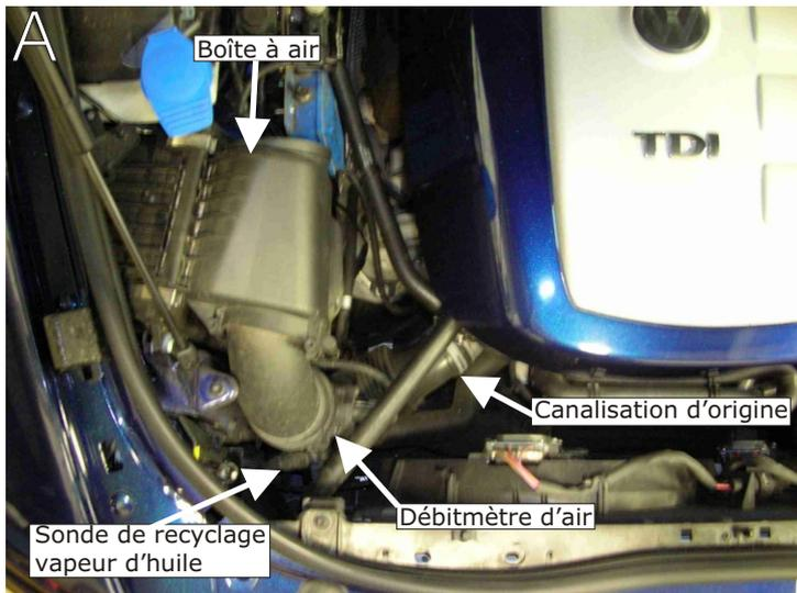
Déposer et supprimer la boîte à air d'origine.(schéma A)
