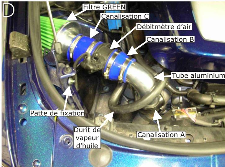
Positionner le filtre à air GREEN sur le débitmètre d'air à l'aide de la canalisation C du kit. (Schéma C et D)
