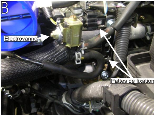
Positionner l'électrovanne sur la patte de fixation du faisceau d'origine à l'aide des pattes de fixation du kit.(schéma B)
