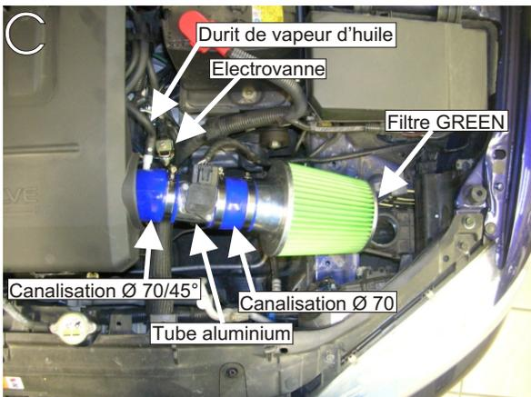
Positionner la canalisation Ø 70/45° sur le boîtier papillon des gaz.(schéma C)
