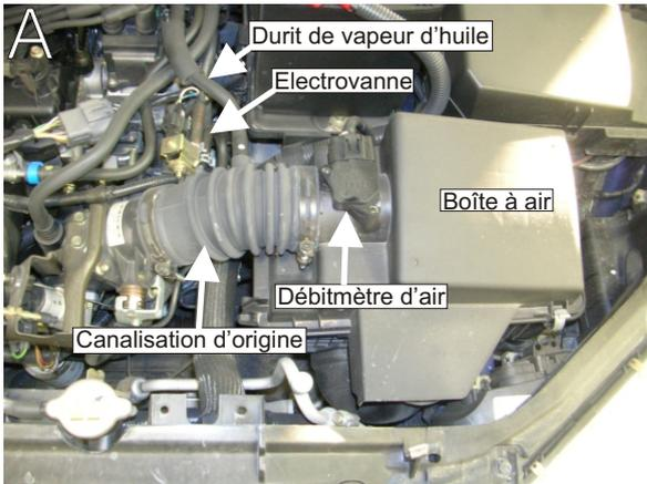
Déposer et supprimer la boîte à air d'origine ainsi que la canalisation d'origine.(schéma A)
