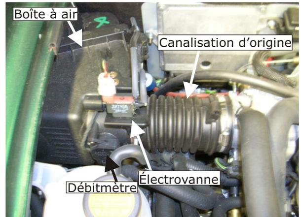
Déposer et supprimer la boîte à air complète. Désaccoupler l'électrovanne de la boîte à air. Déposer et supprimer la canalisation d'origine. Désaccoupler le débitmètre de la boîte à air.
