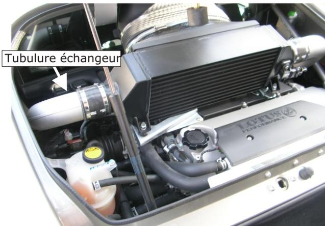
Le montage sur la LOTUS EXIGE S est identique aux deux autres modèles sauf pour le démontage de la boîte à air et l'installation du kit il faut déposer la tubulure de l'échangeur d'air voir la photo.
