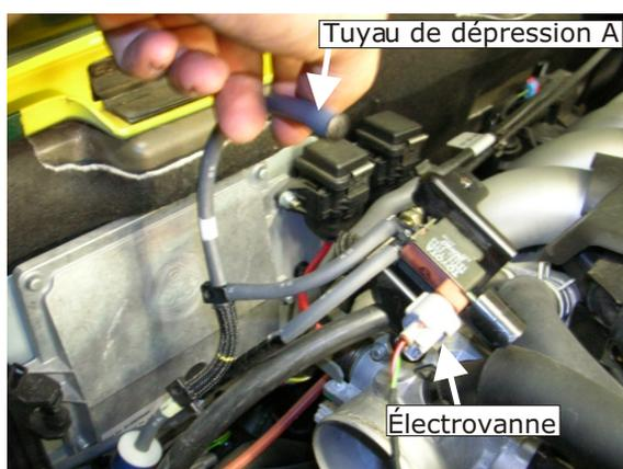
Positionner l'obturateur du kit sur le tuyau de dépression A.
