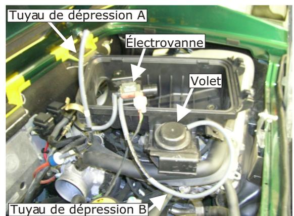
Positionner l'obturateur du kit sur le tuyau de dépression B.
