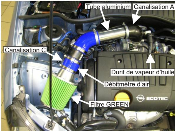
Positionner la canalisation A du kit sur le boîtier papillon des gaz.
