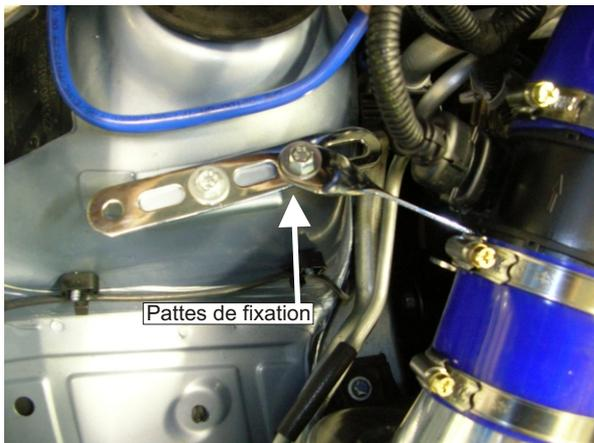
Fixer le filtre à air GREEN à l'aide des pattes de fixation sur le support de la boîte à air d'origine.
