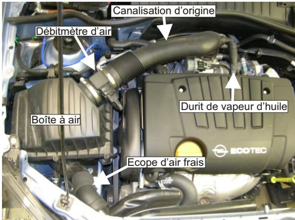
Déposer et supprimer la boîte à air complète ainsi que la canalisation d'origine et l'écope d'air frais.
