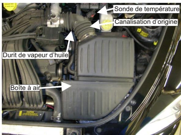
Déposer et supprimer la boîte à air d'origine ainsi que la canalisation d'origine et la durit de vapeur d'huile.
