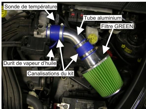
Positionner le tube aluminium sur la canalisation du kit.
