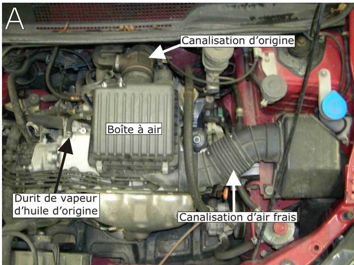
Déposer et supprimer la boîte à air complète ainsi que la canalisation d'origine et la canalisation d'air frais. (Schéma A)
