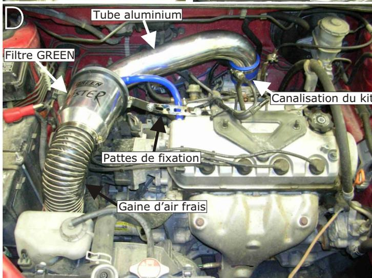
Positionner la durit de vapeur d'huile du kit en lieu et place de celle d'origine. (schéma C et D)
