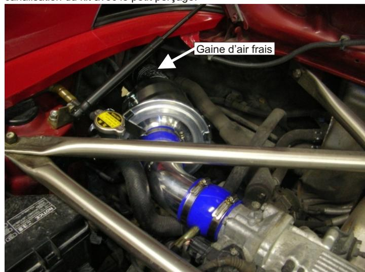
Emboîter la gaine d'air frais sur le filtre TWISTER puis la positionner derrière l'ouïe latérale.
