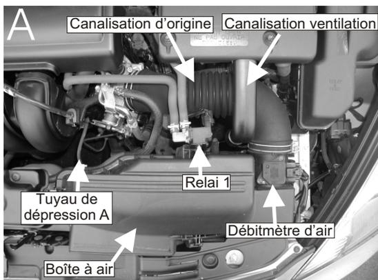
Désaccoupler les relais 1 et 2 de la boîte à air.(schéma A)
