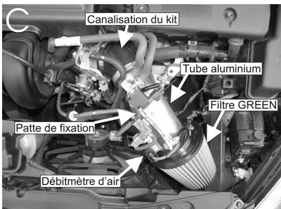
Emboîter le raccord du kit sur le tuyau de dépression A puis le relier au tuyau de dépression C du relai 2.(schéma B et C)
