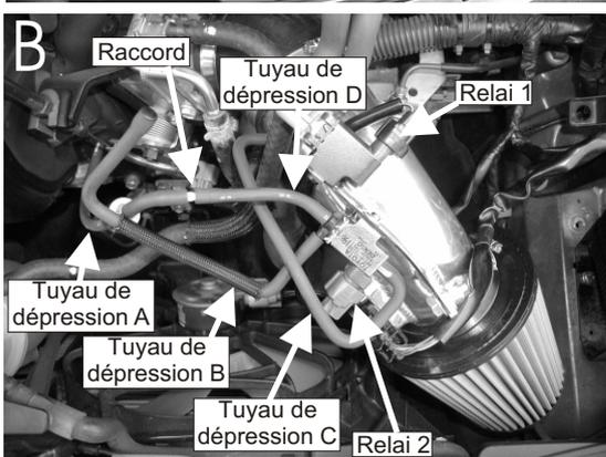
Positionner la canalisation du kit sur le boîtier papillon des gaz.(schéma B et C)
