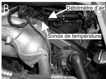
Désaccoupler le débitmètre d'air ainsi que la sonde de température de la boîte à air.(schéma B)
