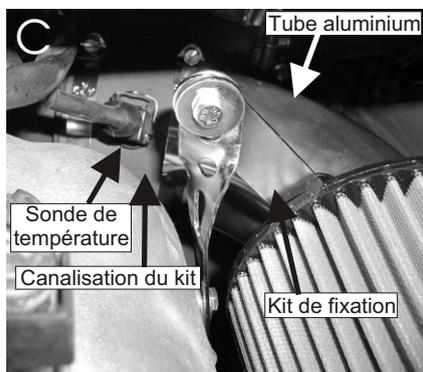
Emboîter la canalisation du kit sur le débitmètre d'air.(schéma C)
