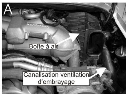
Déposer et supprimer la boîte à air complète.(schéma A)
