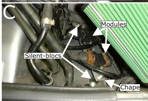
Fixer les modules à l'aide des vis d'origines.
