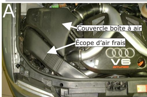
Déposer et supprimer le couvercle de la boîte à air ainsi que l'écope d'air frais.(schéma A)
