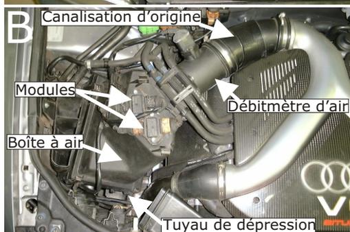
Désaccoupler le débitmètre d'air de la boîte à air.(schéma B)
