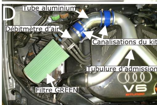
Positionner le tube aluminium sur la canalisation du kit.(schéma D)
