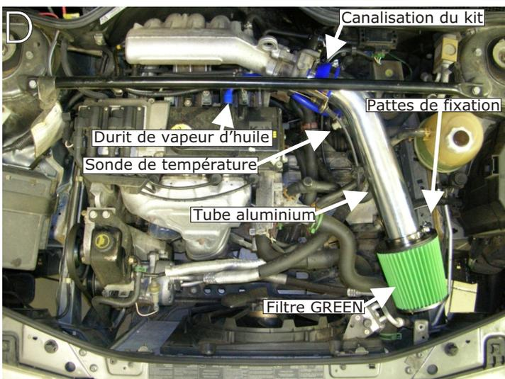
Emboîter la sonde de température sur le tube aluminium.(schéma B)
