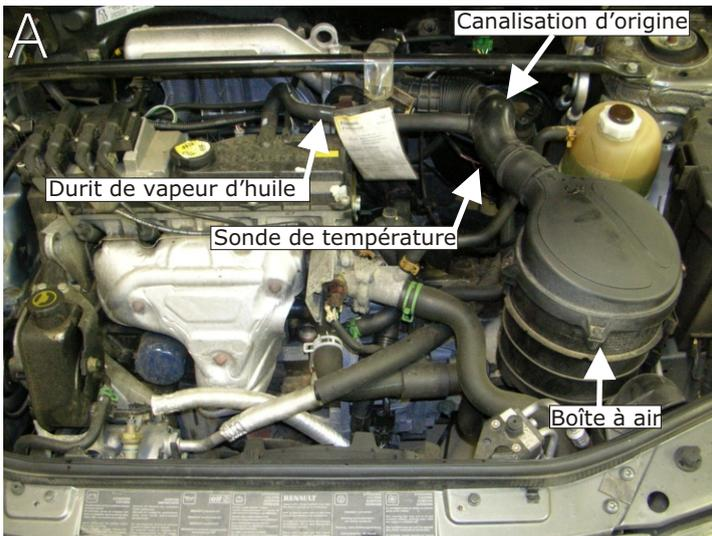
Déposer et supprimer la boîte à air complète ainsi que la canalisation d'origine et la durit de vapeur d'huile.(schéma A)
