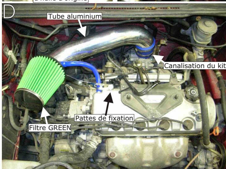
Emboîter le filtre à air GREEN sur le tube aluminium. (Schéma C et D)
