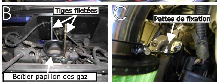
Positionner la canalisation A du kit sur le boîtier papillon des gaz.(schéma D)
