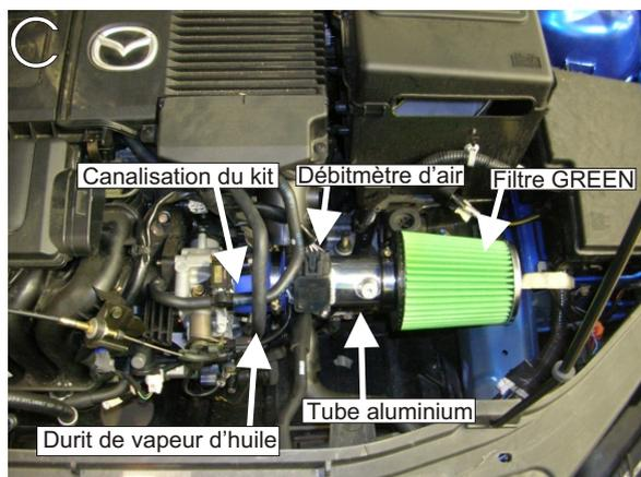
Emboîter le filtre à air GREEN sur le tube aluminium.(schéma C)
