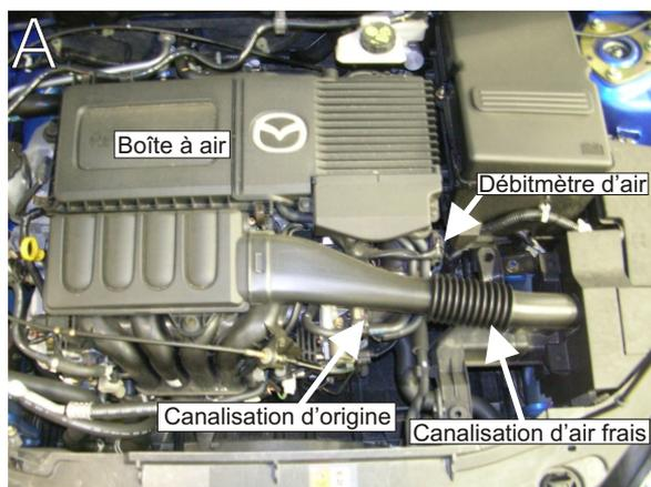
Déposer et supprimer la canalisation d'air d'origine ainsi que la canalisation d'air frais.(schéma A et B)
