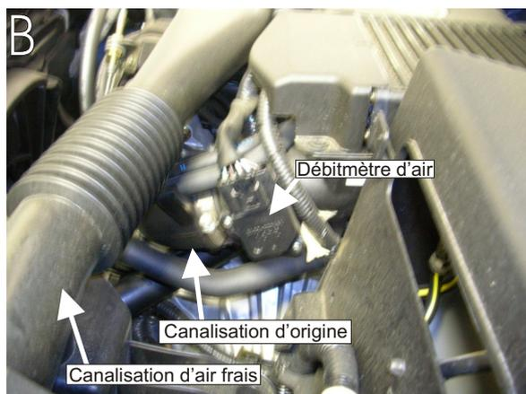
Positionner le débitmètre d'air sur le tube aluminium, puis le fixer à l'aide des vis fournies.(schéma C)
