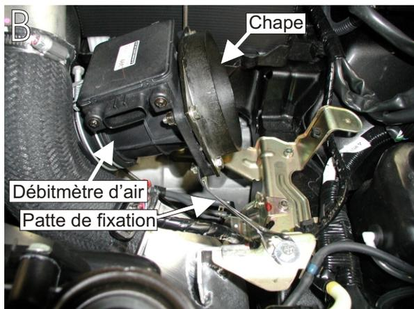
Positionner la chape fournie dans le kit sur le débitmètre d'air.(schéma B)
