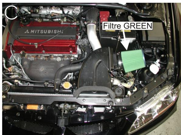
Emboîter le filtre à air GREEN sur la chape du kit.(schéma B)
